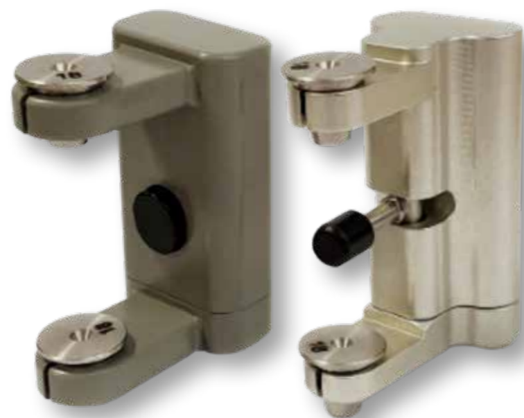
Пример за втулки, фиксирани в иглен водач.
